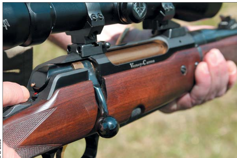
A l'arrière de la culasse, en rouge, l'indicateur d'armement, et en jaune, au-dessus, le témoin de présence d'une cartouche dans la chambre. Rien ne manque.
