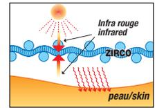
Au cœur même du polyester ont été insérées des nanoparticules de dioxyde de zirconium (ZR02), une des molécules les plus performantes en ce qui concerne la capacité d'isolation thermique.
