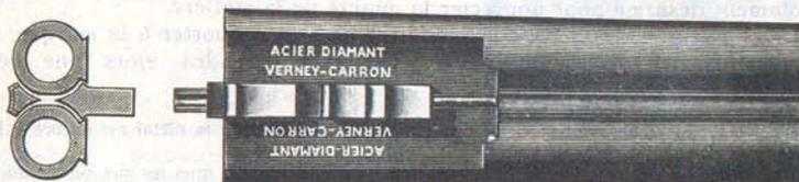
Dans le premier MODE, la bande et les crochets sont indépendants des tubes auxquels ils sont ajustés et soudés, à l'aide d'un alliage spécial.
