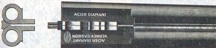
Le deuxième MODE d'assemblage est utilisé dans les canons des armes de prix au-dessus de la moyenne. Il diffère du premier en ce que les crochets sont relevés au moment de la forge sur le massif même des tubes, chaque canon apporte sa demi-partie de crochet.
