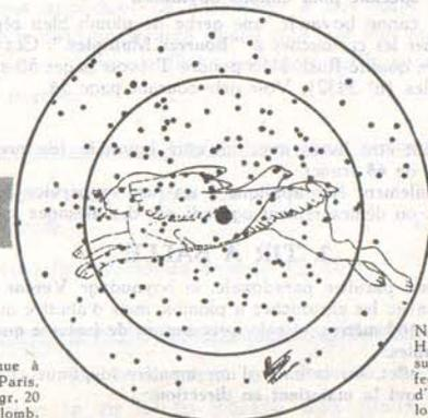
Réduction d'une cible obtenue à 35 mètres, plomb n° 7 de Paris, calibre 12, avec charges : 2 gr. 20 de poudre T et 32 gr. de plomb.
